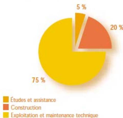
Répartition moyenne des types de coûts sur le cycle de vie d'un bâtiment tertiaire (hors foncier et frais financiers)
